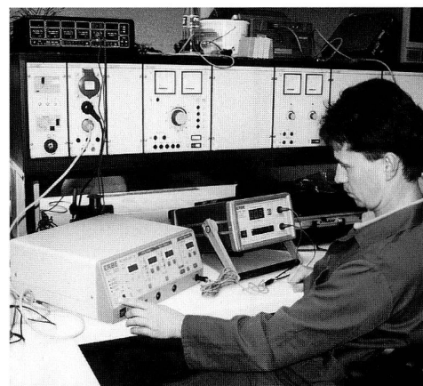
Mitarbeiter der Medizintechnik im Krankenhaus Ried bei der Überprüfung eines Hochfrequenz-Chirurgiegerätes.
