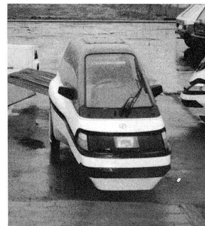
«mini-el»-Fahrzeug mit Thermoplast-Karosserie.
