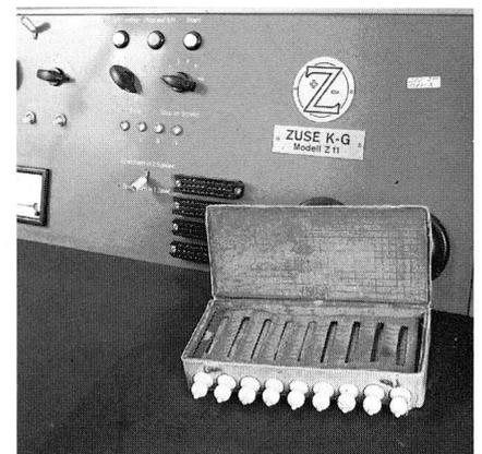
Ausschnitt des Bedienungspultes der Relaisrechenanlage Zuse Z 11 von 1957; davor das Schottsche Rechenkästchen von 1668, mit drehbaren Multiplikationszylindern.
