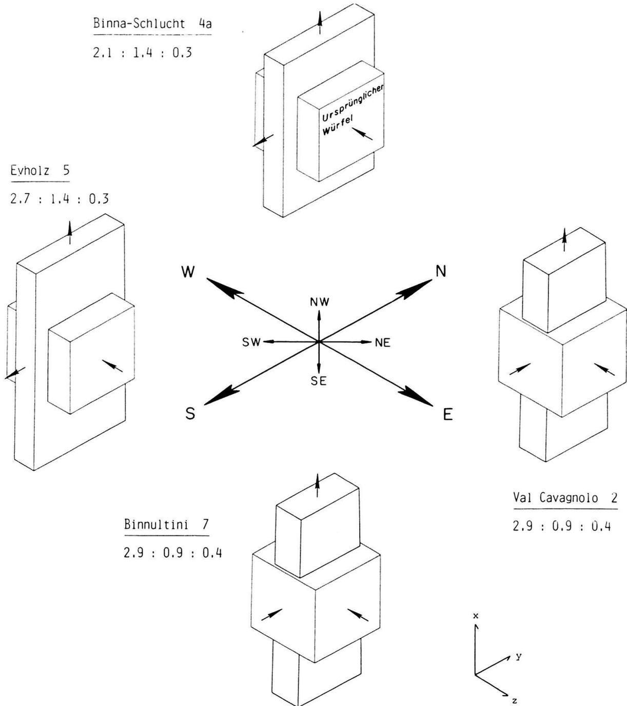
Fig. 16. Die absoluten Deformationsbeträge als verformte Kuben im regionalen Umfeld dargestellt (x, y und z = Achsen des Deformationsellipsoides).
