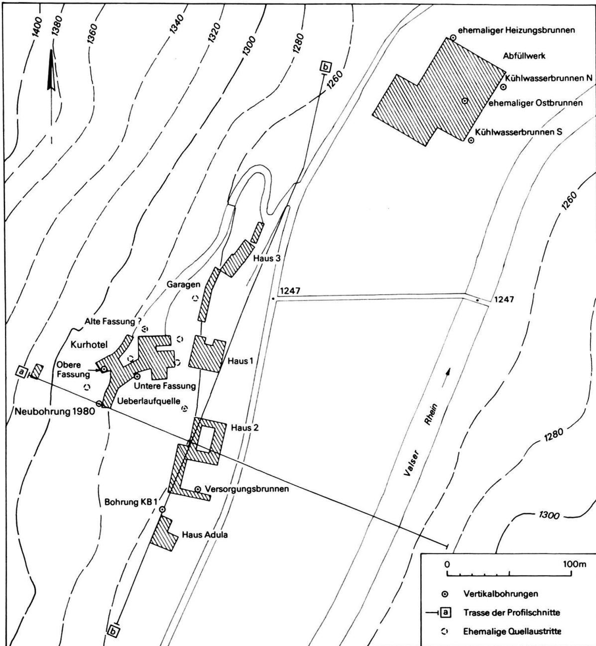
Fig. 2. Situationsplan der Valsen St. Petersquelle und der zugehörigen Gebäude, mit Eintrag der Vertikalbohrungen, der ehemaligen Quellaustritte und den Trassen der Profilschnitte (*a* = Fig. 4, *b* = Fig. 5).
