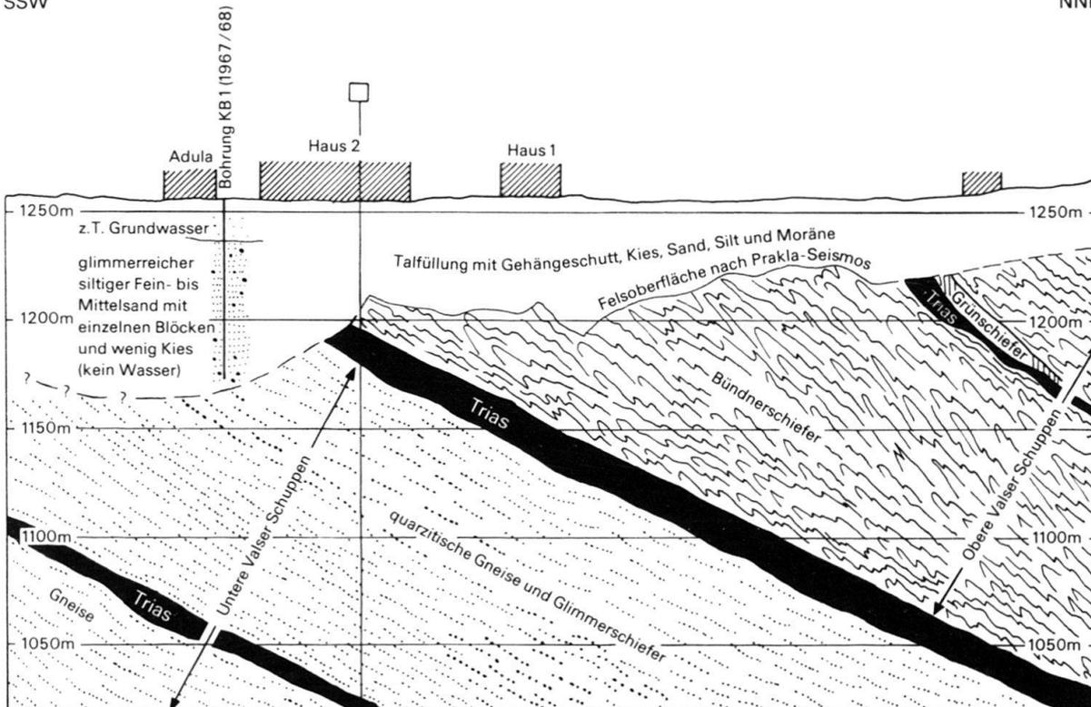
Fig. 5. Geologisches Profil parallel zur Richtung des Valsler Rheins durch den Untergrund des Kurhotelareals (= Trasse *b* auf Fig. 2 und 3). Nicht überhöht.
