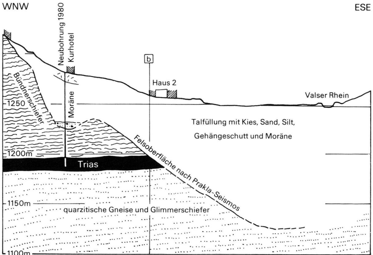
Fig. 4. Geologisches Profil quer zur Richtung des Valser Rheins durch die Neubohrung 1980 (= Trasse a auf Fig. 2 und 3). Nicht überhöht.
