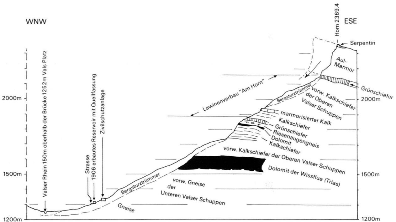
Fig. 6. Geologisches Profil durch die Talflanke von Vals Platz zum Horn hinauf. Nicht überhöht.
