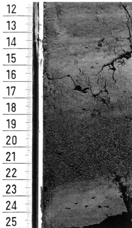
Fig. 6. Diffuse Schichtung über und unter einer gradierten Sandlage (Kern 14).
