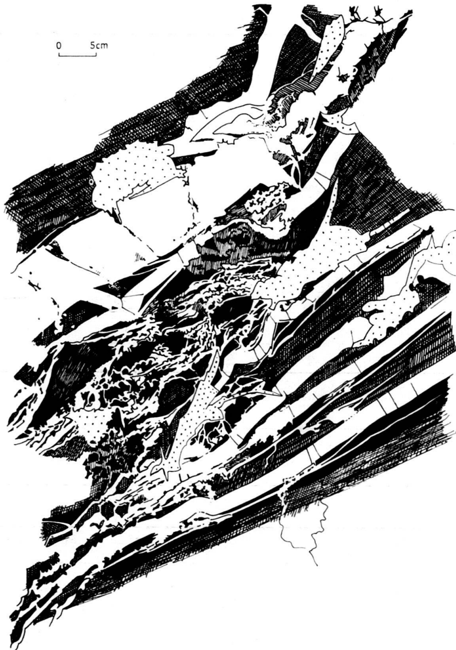
Fig. 3. Detailausschnitt des Systems von Fig. 2. Die Gänge (weiss) sind oft papierdünn, und ihre Verflechtung ist mancherorts von fast kapillarer Feinheit. Verfaltung und sogar Vermischung mit dem Wirtsgestein sind häufig. Das Gangnetz ist nicht isotrop, sondern deutlich in der Schichtung ausgerichtet. Offenbar stellt diese Zone eine mit der Intrusion syngenetische Bewegungsschicht dar. Punktierte Flächen: Laub- und Schuttbedeckung.
