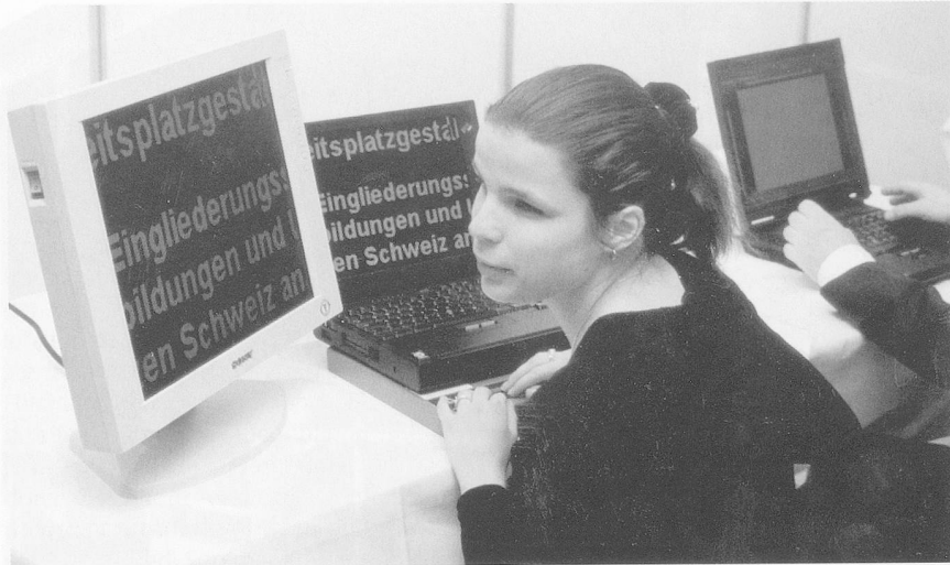
Eine sehbehinderte Frau am Computer, der vorne, zusätzlich zur normalen Tastatur, mit den Zeichen der Blindenschrift versehen ist. Die gewöhnliche Maschinenschrift kann bis 60fach vergrössert werden. Foto Arthur Dietiker
