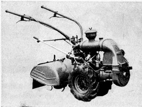
baugeräten, die vor der Maschine arbeiten (Rasenmäher, Schneeschaukel, Strassenbürste), notwendig ist. Auch besitzt die Maschine einen Rückwärtsgang, welcher bei Zugarbeiten und beim Fräsen von kleinen Parzellen oder in Gärten mit Bäumen und Hecken ein grosser Vorteil ist.
