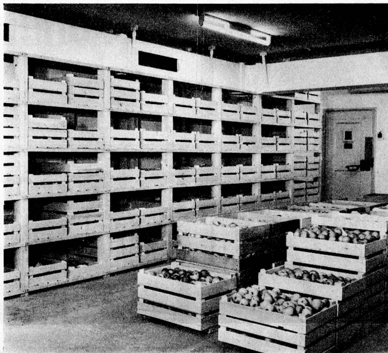
Das Harassgestell hat sich gerade in Anstalten als sehr zweckmässig für die Obstlagerung erwiesen
