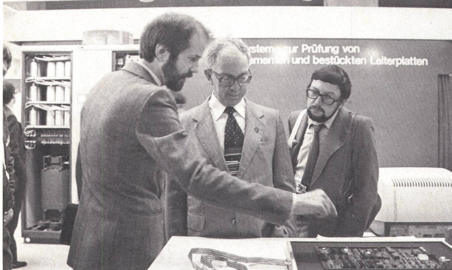
L'électronique et la microélectronique ont permis de développer des automates pour le contrôle de la qualité des produits finis, à l'image de cette machine vérifiant le fonctionnement d'une plaque entière de circuits imprimés entrant dans la fabrication d'un central téléphonique
