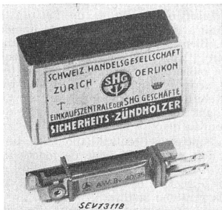
Fig. 5. Miniaturrelais des Impulswiederholers (Grössenvergleich mit einer Streichholzschaftel) Relais miniature du répéteur d'impulsions (grandeur comparée à celle d'une boîte d'allumettes)
