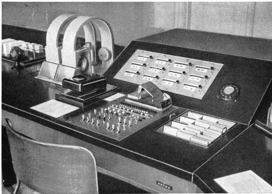
Abbildung 22. Fernanmeldeplatz mit Rohrpost.
