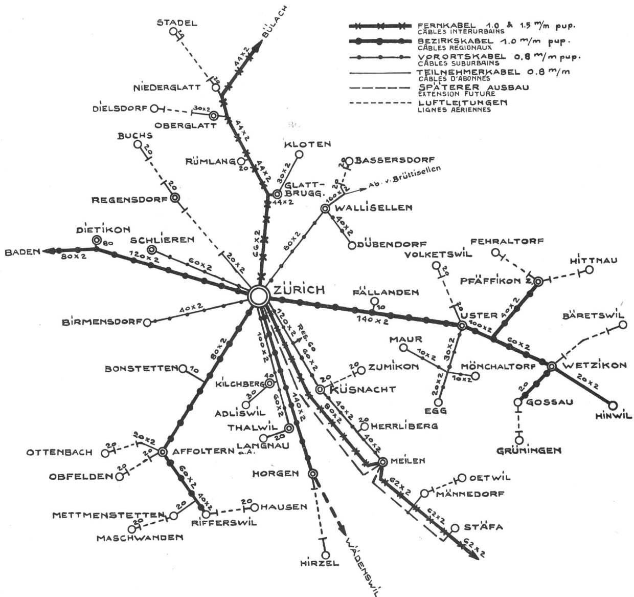
Fig. 10. Kabelnetzplan. — Plan du réseau des câbles.
