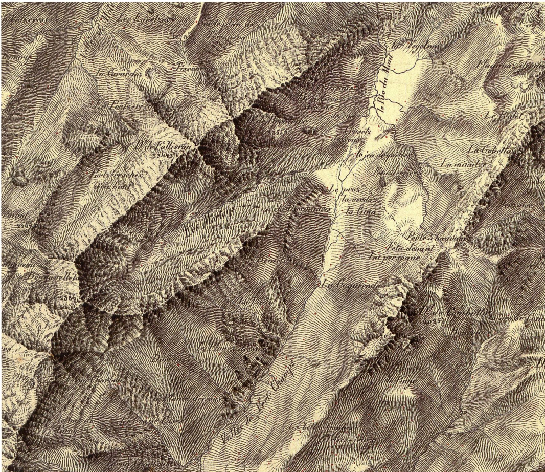
Abb. 45 (Seite 34 oben): Musterzeichnung 1:50 000 für Blatt XVII, Subdiv.4. Damit wollte Dufour die Wirkung der angestrebten Felsdarstellung und der Schattenschraffen testen. Farbige Tuschezeichnung von Isaac Christian Wolfsberger, 1841/42. Format der Musterzeichnungen: 70x48 cm. Ausschnitte im Originalmassstab (swisstopo Kartensammlung, TKZ Studien 17 4).
