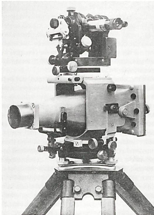
**Abb. 38:** Phototheodolit Wild mit grosser Kamera, von der Firma Wild in Heerbrugg nicht zuletzt aufgrund der Erfahrungen des Vermessungsdetachements Gotthard konstruiert und an der Landestopographie ab der Mitte der 1920er-Jahre auch bei den Originalaufnahmen zu den Festungskarten im Einsatz (swisstopo, Bildsammlung, Technische Aufnahme 3663b).
