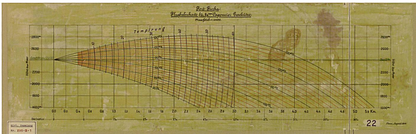
**Abb. 8:** Flugbahnkarte für 8,4 cm Caponnier-Geschütze für das Fort Furka (Galenhütten), Massstab 1:10 000, erstellt in Thun im August 1900. Solche Flugbahnkarten waren für die verschiedenen Geschütztypen anzufertigen und beruhten auf umfangreichen Schiessversuchen. Sie geben im Wesentlichen die Elevation wieder, die am Geschütz einzustellen war, damit ein Ziel in einer bestimmten Entfernung und Höhendifferenz beschossen werden konnte (BAR, E5480A-01#1975/39#6).
