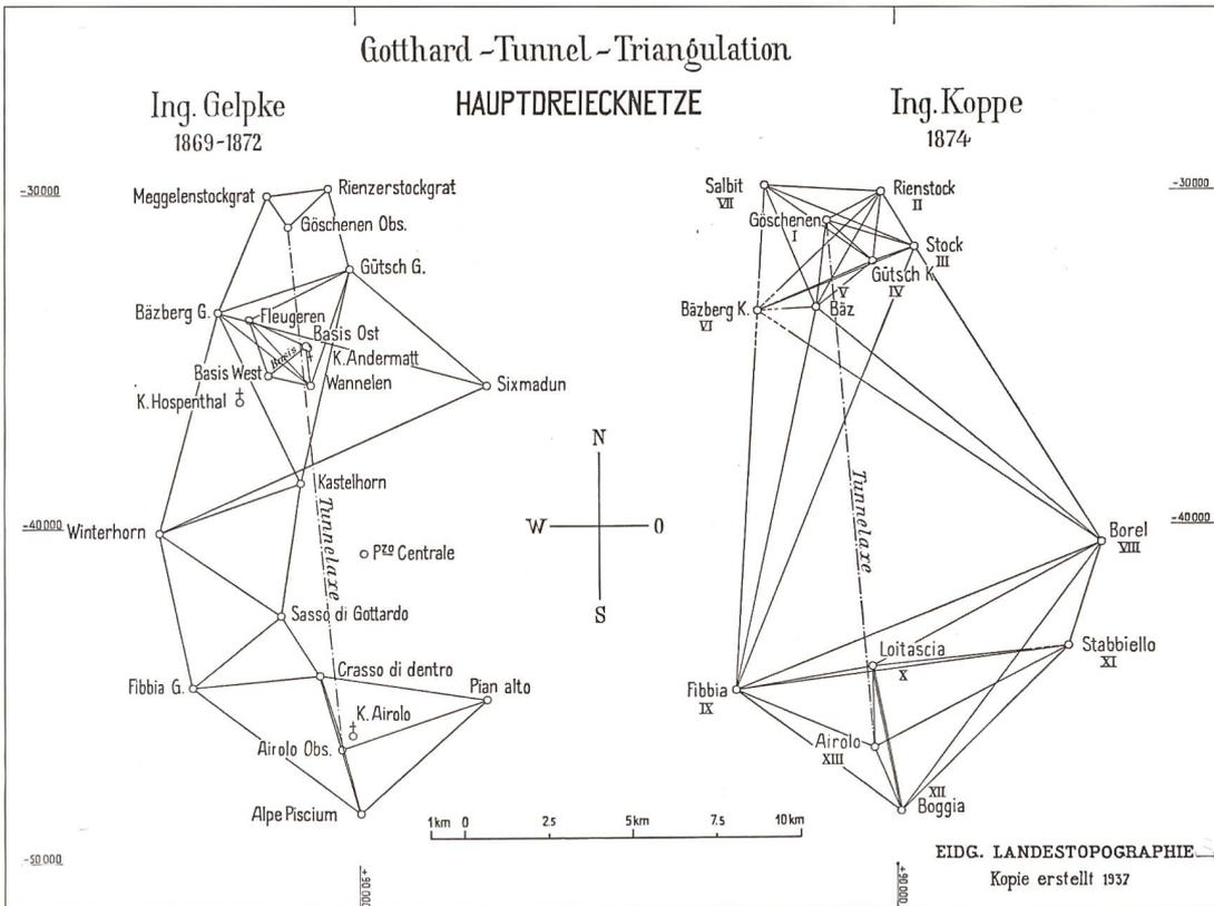
**Abb. 10:** Hauptdreiecke der beiden Netze der Gotthard-Tunnel-Triangulation, welche als sogenanntes «Gotthardsystem» die geodätische Grundlage der Festungskarten in dieser Gegend bildeten (Zölly (1948), S. 93, Abb. 64).
