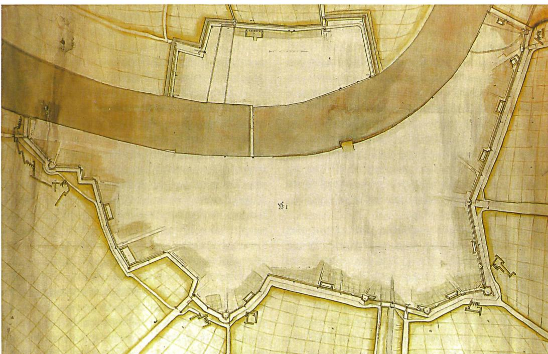
**Abb. 3:** Die erste der vier «Visierungen von Daniel Specklin über Fortification der Stadt» Basel von 1588, auf der Grundlage der Vermessung durch Hans Bock d.Ä. Frühes Beispiel eines Planes für das Befestigungsprojekt einer Stadt (StABS, Planarchiv, T 4, 1).
