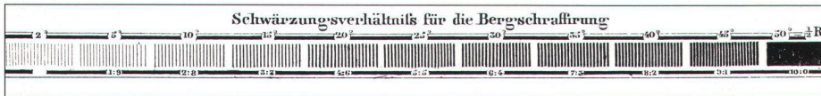
Abb. 4: Die Skala für das Schwärzungsverhältnis der Böschungsschraffen nach Johann Georg Lehmann (Ausschnitt aus Blatt 19).
