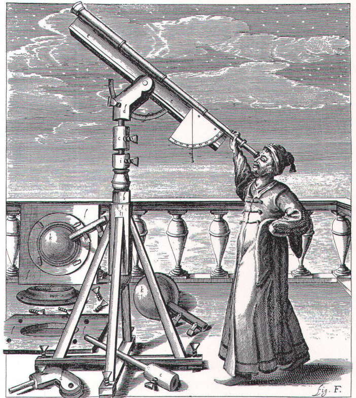
Abb. 2. Der Astronom am Teleskop. Neben der «Mondbeschreibung» kündigte Hevelius auf der Titelseite seines Werkes ein «neues Verfahren» an, «Linsen zu schleifen», so auch «eine Anleitung, verschiedenartige Teleskope zu konstruieren». Die Buchstaben im Bild beziehen sich auf die Bauanleitung.
