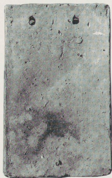
Fig. 118. Tuile à découpe droite pourvue de deux trous ronds en lieu et place du talon (Chésérèx, église Notre-Dame de Bonmont).
