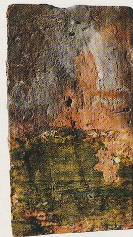
Fig. 65a-b. Tuiles trouvées sur la tour-lanterne de la Cathédrale de Lausanne et décorées d'un vernis vert foncé sans engobe (a) ou vert sur engobe clair (b).
