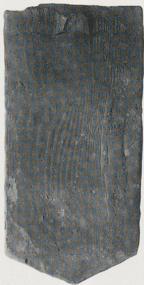
Fig. 28. Le négatif de la planchette de bois ayant servi de foncet est souvent resté imprimé sur la surface intérieure, mais uniquement pour les tuiles striées avec les doigts (Moudon, Musée du Vieux-Moudon).
