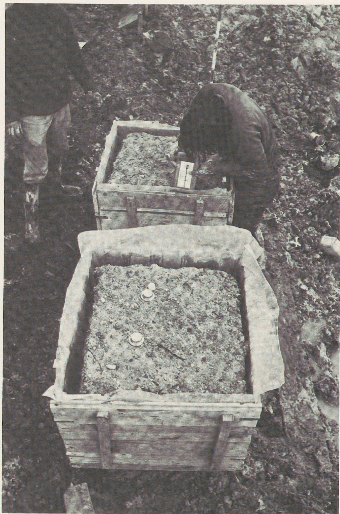
Fig. 18 Coffrage des blocs-échantillons; le polystyrène expansé est en cours de coulage.
