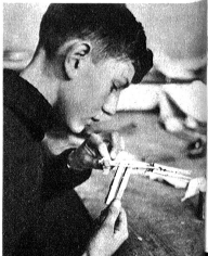
Beim Verleimen der einzelnen Bauteile sind Wäscheklammern ein wertvolles Hilfsmittel; ja, sie sind sogar unentbehrlich
