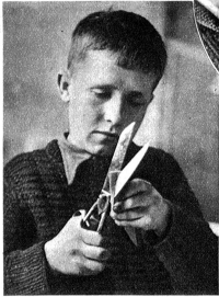
Ausschneiden einer Flügelrippe aus Sperrholz
