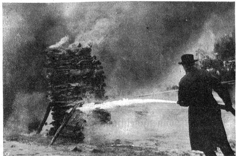
Löschten eines brennenden Holzstoßes. Der Schaum bricht wie ein Wasserstrahl aus dem Wendrohr hervor.
