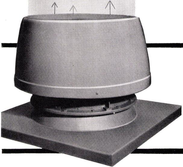
**WOODS-JET Strahl-Dachentlüfter** saugt schädliche Gase, Rauch, Dampf, staubige Luft oder überschüssige Wärme zwangsläufig, blitzschnell ab und schleudert die Abgase in einem vertikalen Strahl von hoher Geschwindigkeit in beträchtliche Höhe, so dass ein Zurückfallen kaum mehr möglich ist. WOODS-JET lässt sich auf Schräg- und Flachdächern einfach montieren. Absolute Betriebssicherheit!
