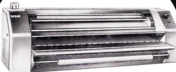
Papierdurchlaß 110 cm, Leistung pro Min. 40-130 cm, Max. Geschwindigkeit pro Min. 0-180 cm, Lichtquelle 4 x 65 Watt mit Reflektor, Anschluß 220 Volt, 2 Ampère, Stromverbrauch 300 Watt, Länge 170 cm, Tiefe 50 cm, Höhe 54 cm, Gewicht 137 kg.
