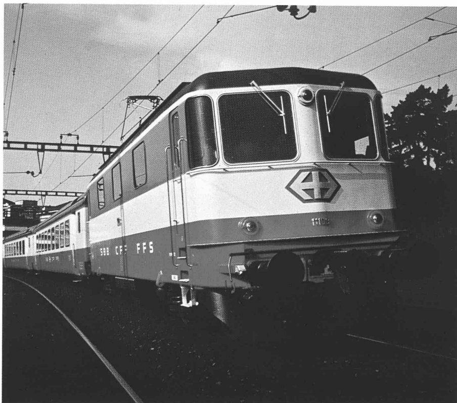
Fig. 12. — Rame automotrice de banlieue 3320 CV, 125 km/h.
