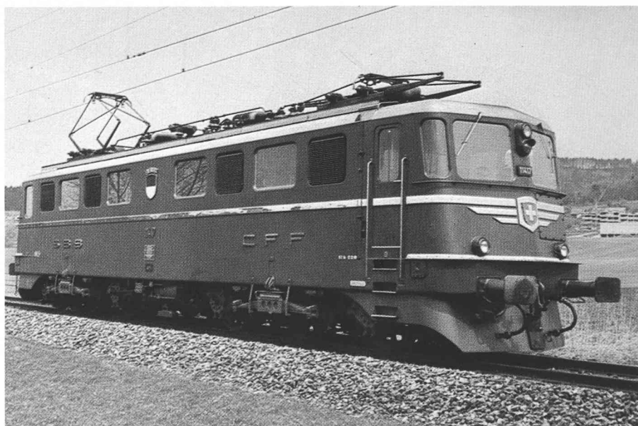
Fig. 9. — Locomotive Ae 6/6 pour trains directs et de marchandises : 6000 CV, 125 km/h.
