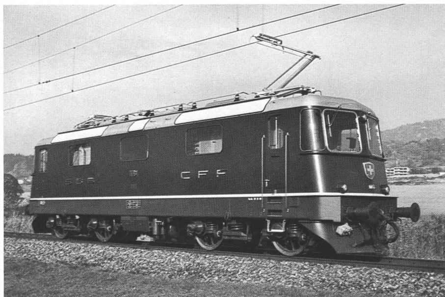
Fig. 9. — Locomotive Ae 6/6 pour trains directs et de marchandises : 6000 CV, 125 km/h.
