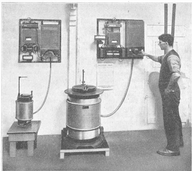
Fig. 2. — Fours Wild-Barfield, type «vertical».
