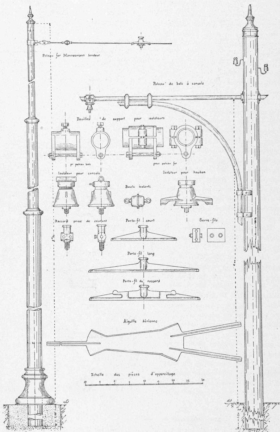
Fig. 13. — Matériel d'appareillage des lignes aériennes établies en 1895.
