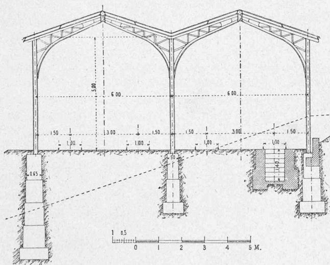
Fig. 19. — La remise des voitures des Tramways lausannois à la Solitude, pendant la 1<sup>re</sup> période d'exploitation (1895-1903). — Coupe transversale.
