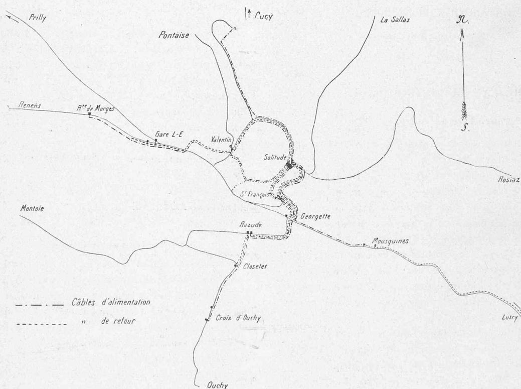
Fig. 12. — Schéma des câbles d'alimentation et de retour.
