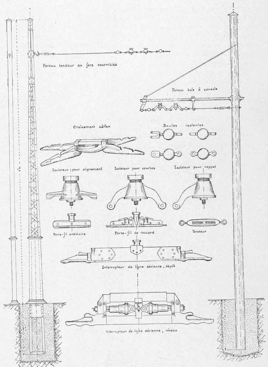
Fig. 14. — Matériel d'appareillage des lignes aériennes établies en 1903.
