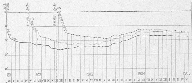
Fig. 54. — Refroidissement progressif du rocher dans la galerie parallèle et son réchauffement à la suite du passage dans cette galerie des eaux chaudes de l'avancement.
