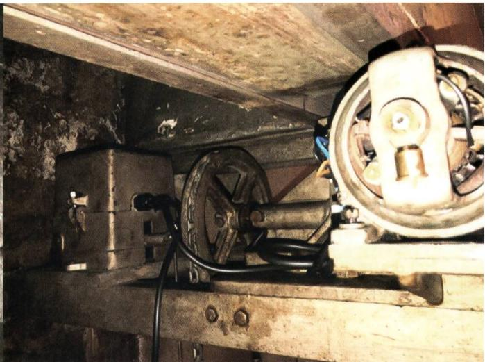
Figures 7 et 8. Le moteur servant à remonter la masse du mouvement qui entraîne le papier, sa plaque signalétique, son origine (École d'électrotechnique du Technicum du Locle) et son installation avec à gauche le relais servant à enclencher et déclencher le moteur.
