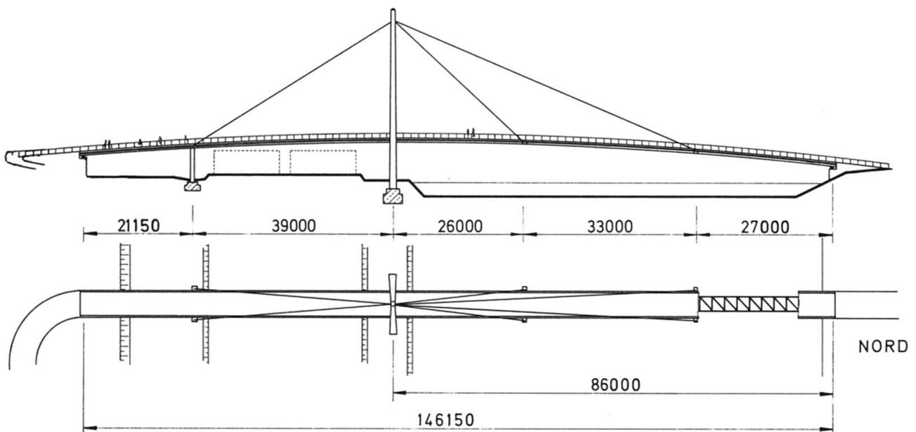
Die 1,85 m hohen, geschweißten Hauptträger sind stetig gekrümmt und wurden aus ästhetischen Gründen nur innenseitig mit Längs- und Quersteifen ausgesteift.
