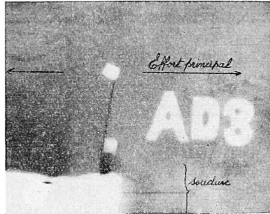
Fig. 9. Défaut et rupture de deux éléments se raccordant à angle vif.
