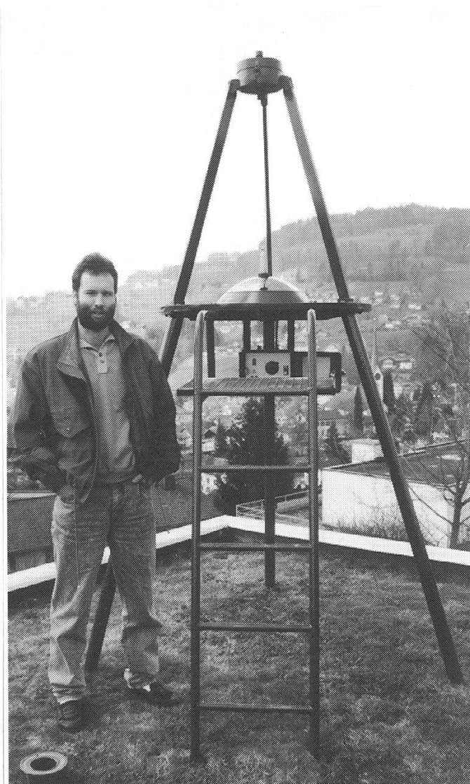
Abb. 2: Mit einer Leiter gelangt der Operateur jeweils hinauf zum Kameragehäuse an der Dreibeinsspitze. Die Spiegelsäuberung und das Entfernen von Spinnweben gehören ebenfalls zu seinen Aufgaben.
