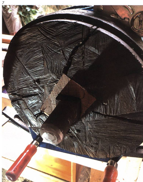
Abb. 10 Die neuen Stege des Korbrades am Wellbaum.
