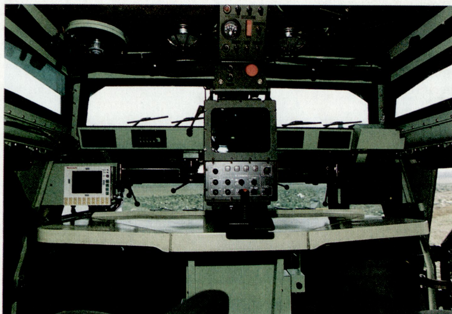
Innenansicht des Fahrzeuges für Schiesskommandanten: Arbeitsplätze des SKdt (rechts) und des Vermessers (links). Foto: Gruppe Rüstung ■
