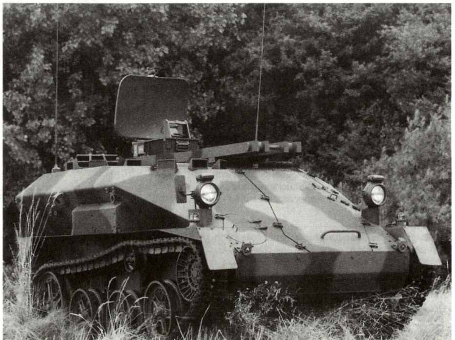
Prototyp des mobilen Überwachungsradars «Ratac-S» auf dem Luftlandpanzer «Wiesel».
