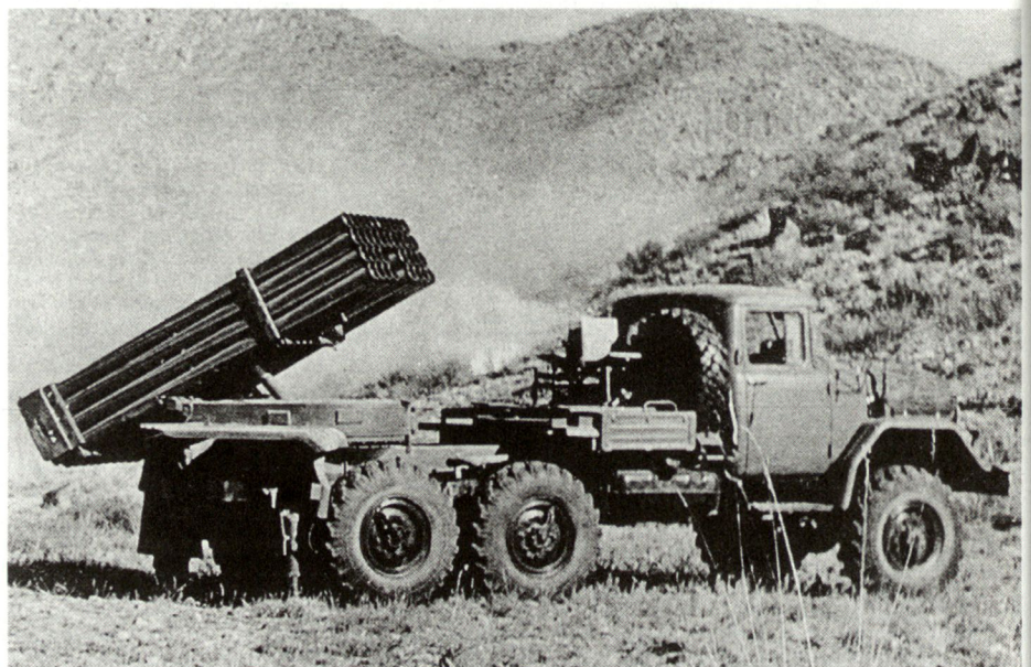
Abb. 1: Mehrfachraketenwerfer BM-21 «Grad» 122 mm mit einer Reichweite von 20,5 km.
