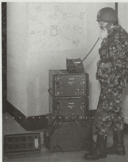
Bild 7. Mögliche Auslegung eines Endvermittlers der Teilnehmerebene für 30 Teilnehmer ausgerüstet. Die Vermittler befinden sich erst in Planung.
