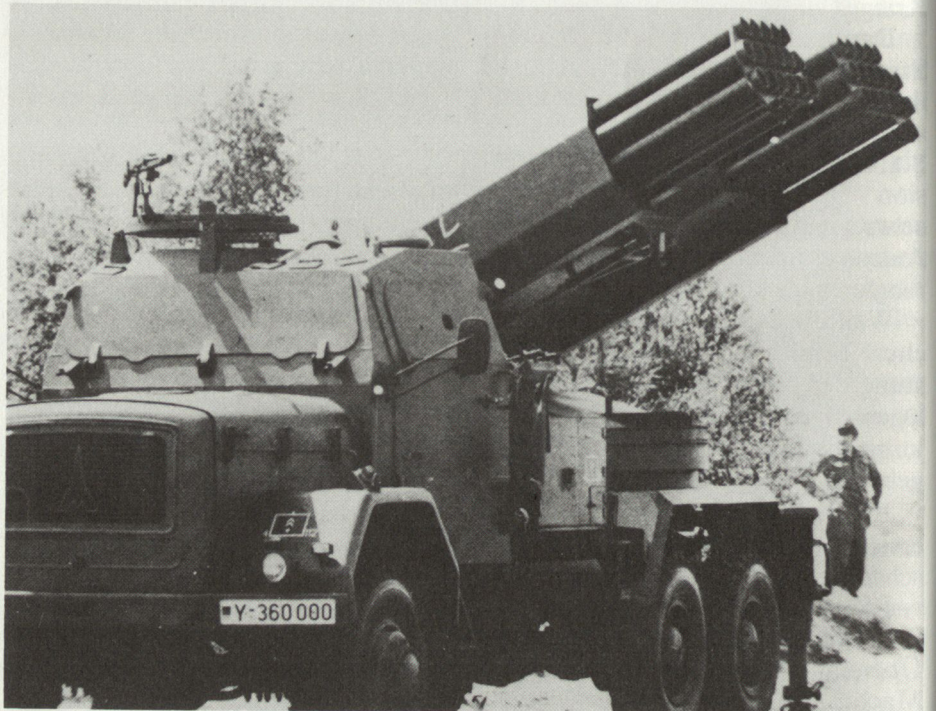
110 mm Mehrfachraketenwerfer LARS (BRD)
