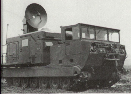
Flugbahnvermessungs- und Feuerleitgerät FIELDGUARD (als FERA in der BRD eingeführt)
