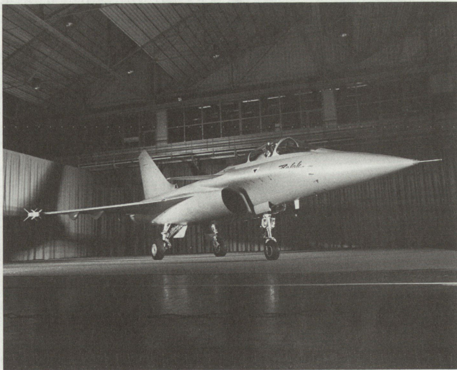
Bild 1. Der Vorserie-Prototyp «Rafale». Vorerst handelt es sich um ein einsitziges Mach-2-Jagdflugzeug von 9,5 Tonnen Leergewicht und zwei amerikanischen General-Electric-F 404-Triebwerken. Die Serienexemplare werden etwas kürzer, dafür um eine Tonne leichter ausfallen und durch französische Snecma M88-Triebwerke angetrieben. Man beachte die Rumpfform zum ungehinderten Anströmen der grossen Triebwerköffnungen.
