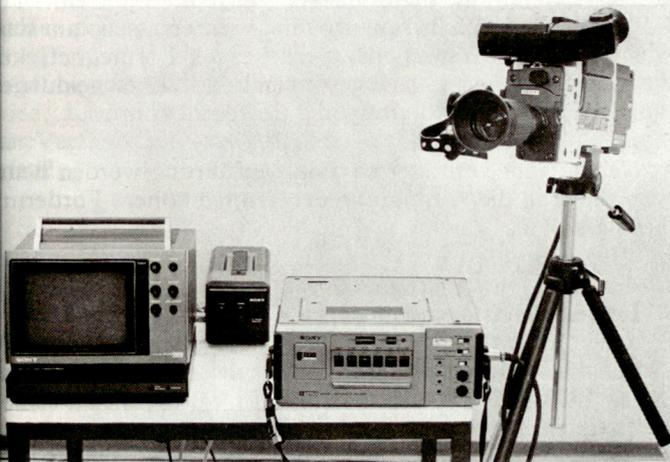
Bild 6. Unterrichtsmitsehuanlage, Ein-Kamera-System.
