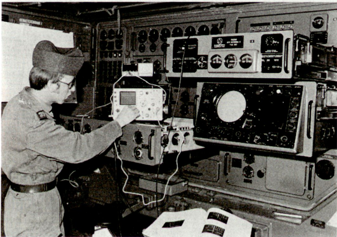
Bild 4. Fehlerlokalisierung durch Flab-Gerätetechnik an Feuerleitgerät.
