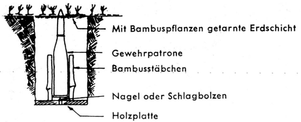
Eine einfach herzustellende Selbstschußvorrichtung mit nachhaltiger Wirkung.
