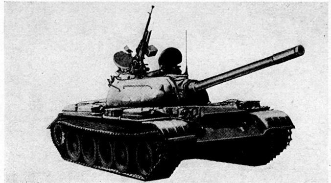
Bild 4. Kampfpanzer T 54. Beachte die flache Bauform der Wanne und des Turmes sowie den charakteristischen Abstand zwischen erstem und zweitem Lauftrad. Über der Ladeschützenkuppel das 12,7-mm-Flab-Mg. Am Heck Halterungen für Zusatz-Betriebsstoffbehälter.
