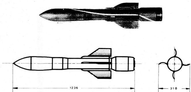
**ROLAND:** Fliegerabwehrwaffe auf unterer taktischer Stufe. Die Rakete weist Deltaflügel sowie zusätzliche Stabilisierungsflügel am vordern Teil auf. Abschub erfolgt aus einem Abschubrohr, das gleichzeitig Transport- und Lagerungspackung darstellt.
