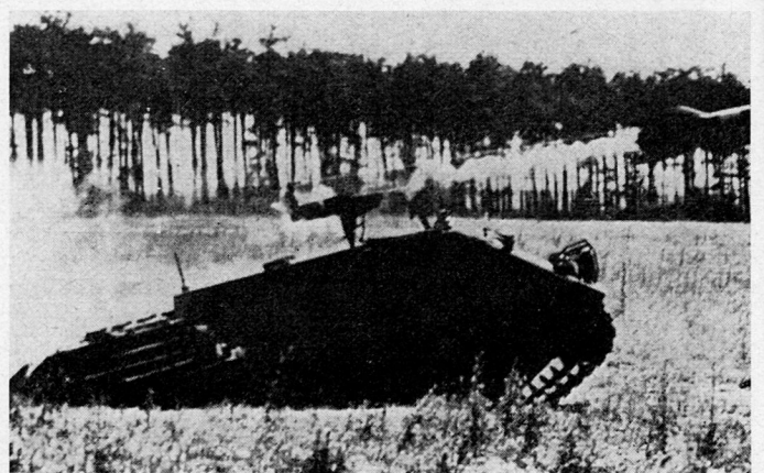
Bilder 3 und 4. Der Raketenjagdpanzer der deutschen Bundeswehr auf Chassis HS 30, ausgerüstet mit zwei versenkbaren Abschußrampen für Lenkraketen SS11 mit einer Höchstkampfwerte von über 3 km
