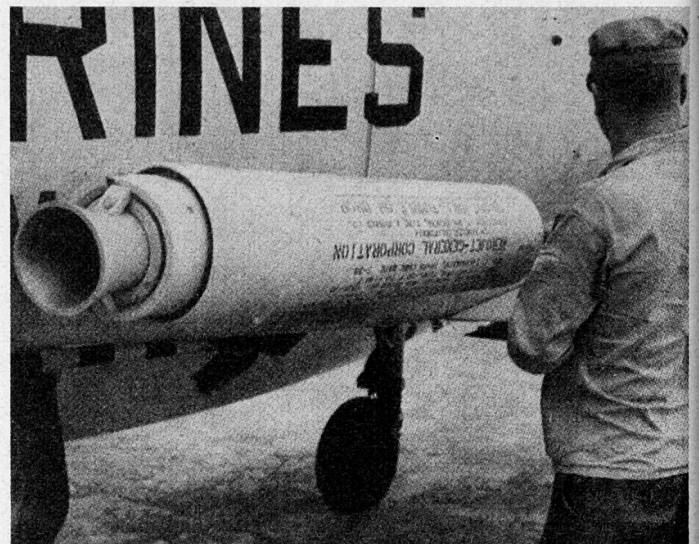
Bild 6. Oben: ein A 4 D der amerikanischen Marine startet mit Jato-Raketen. Man beachte die langen Stichflammen links und rechts des Flugzeuges. – Unten: Installation der Jato-Raketen auf dem A 4 D. Man sieht, daß bereits für relativ kleine Schubleistungen die Dimensionen dieser Raketen beträchtlich sind
