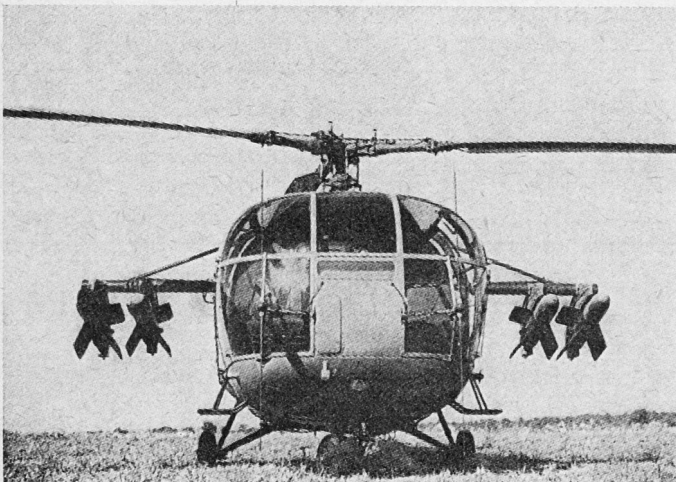
Bild 8. Alouette III mit Panzerabwehrraketen SS-11
