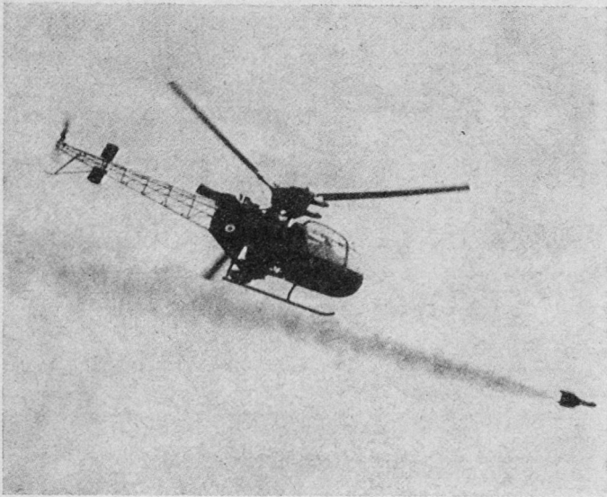
Bild 2. Alouette II, Abschub einer Panzerabwehrrakete SS-11 Transportiert vier Passagiere oder 400 kg Fracht zirka 100 km weit und landet mit Treibstoffvorrat für 45 Minuten Flug bis auf 1700 m über Meer. Bei Landung auf 4000 m über Meer sinkt die mögliche Zuladung auf 100 bis 150 kg
