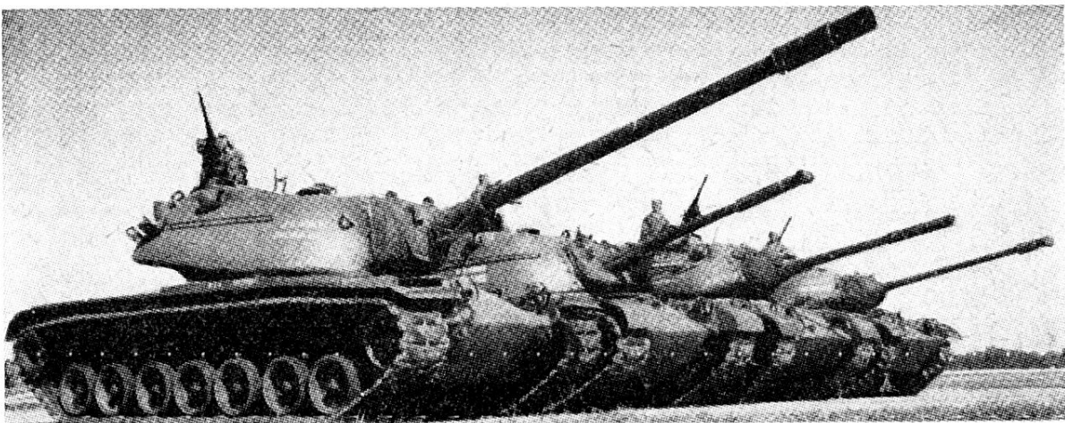
Von links nach rechts: T 43 (60 t), M 48 (48 t), M 47 (48 t) und M 41 (25 t)
