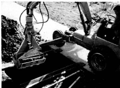
Der neue selbstfahrende Hydraulik-Schmalspur-Bagger für er Friedhofwege, der rationell, arbeitskräftesparend und schu Grabstätten aushebt. Eignet sich auch vorzüglich für die Dur führung von Erdbewegungsarbeiten, Aufladen von Erde, Schu usw., Grabenöffnen für Drainagen usw. Er ist kipp- und standf auch mit Doppelbereifung lieferbar und ausserdem sehr preisw
