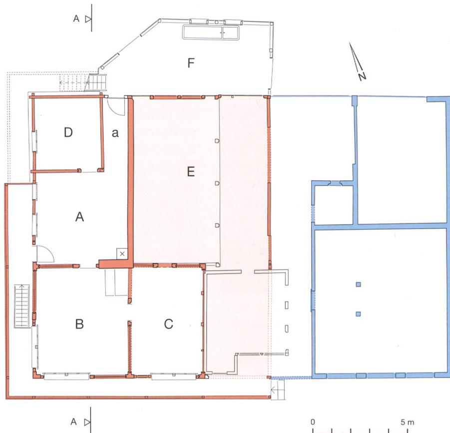
Abb. 5: Thun, Goldiwil, Matthausweg 23. Grundrissaufnahme Stubengeschoß. Rot: Ursprungsbau von 1614: Rauchküche A, Quer-gang a, Grosse Stube B, kleine Stube C, Küchen-kammer D, Stall E und Brunnenstube F; blau: Er-weiterung des Ökonomie-teils von 1967. Aufmass Stubengeschoß Albrecht Spieler. M. 1:200.
